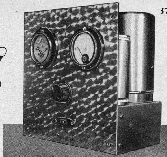
die primäre Gleichspannung messen können. Den Stromverbrauch aus der vorhandenen Gleichstromquelle können wir an dem im Eingang liegenden Weicheisenamperemeter ablesen, dessen Meßbereich sich nach der auftretenden maximalen Stromstärke richtet. Für  $110 \text{ Volt}$  beträgt dieser in unserem Falle  $0-0,5 \text{ Amp.}$ , bei  $12 \text{ Volt}$   $0-4 \text{ Amp.}$  und bei  $6$  bzw.  $4 \text{ Volt}$   $0-6 \text{ Amp.}$
