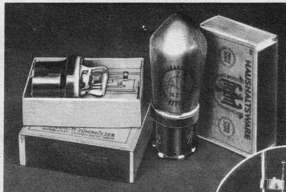
Das gefamte System der neuen Doppel-Zweipolröhre KB 2 ist noch nicht einmal 1 cm groß. Wir haben hier zum Vergleich nicht nur das ganze Röhrensystem in eine Zündholzschachtel gepackt, sondern auch neben das System das Kathodenröhren einer 4-Volt-Wechselstromröhre gestellt. Das Kathodenröhren der KB 2 hat nur 1/3 mm Durchmesser und in diesem Röhren liegt dann noch der Heizfaden von 3/100 mm „Dicke“. Werkphoto Valvo und Photo Herrnkind.
